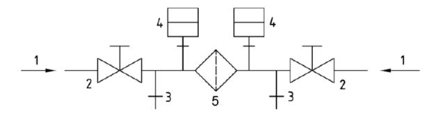
1——施压装置 2——停止阀/电磁阀 3——排污阀 4——压力表 5——试验用过滤器
